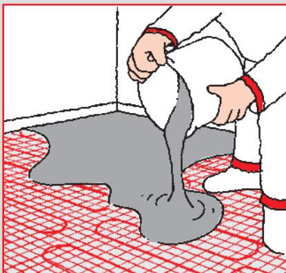
x-plan распределяется над кабелями. Минимальная толщина слоя над кабелями: для стабильных поверхностей (бетон, керамическая плитка) - 2 мм; для подвижных поверхностей (дерево, ДСП, фанера) - 5 мм.
