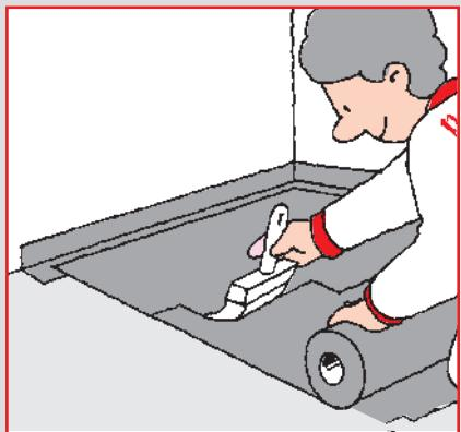
Во влажном помещении поверхность изолируется с помощью 4400 multicoat и safecoat, когда x-plan подсохнет и затвердеет.
