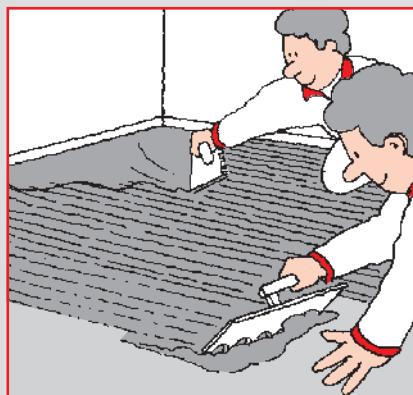
На воспламеняемые поверхности (деревянные, ДСП, фанеру) для защиты наносится 1-2 мм слой 3130 superfix или 3250 superplanfix. Раствор наносится с помощью 4x4 мм зубчатого шпателя и затем разравнивается гладкой стороной. Когда слой подсохнет, укладывается devimat.
