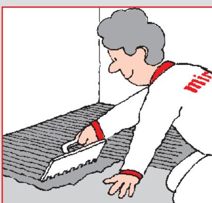
Плитка укладывается с помощью 3130 superfix или 3250 superplanfix. На деревянные (ДСП, фанера) основания применяется 3600 multicrete.
