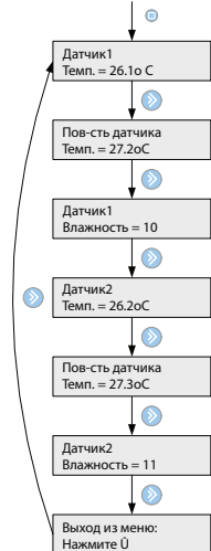
Просмотр показаний датчиков (Система для крыши)
