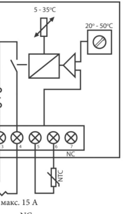
Подключите провода согласно монтажной электрической схеме. При подключении к регулятору питающего сетевого напряжения следует соблюдать фазировку. Терморегуляторы не имеют специального контакта для подключения «земли». Вывод экранирующей оплетки нагревательного кабеля должен соединяться с проводом «земля» питающей сети с помощью дополнительного контакта внутри монтажной коробки.
